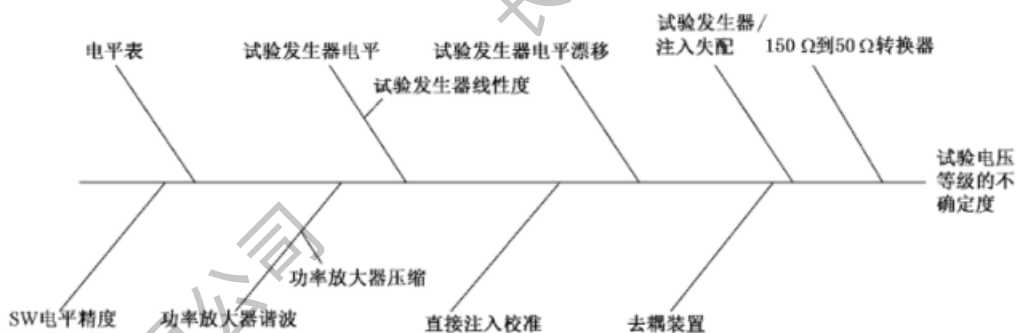
图 G.4 使用直接注入对试验电压电平的影响量示例
